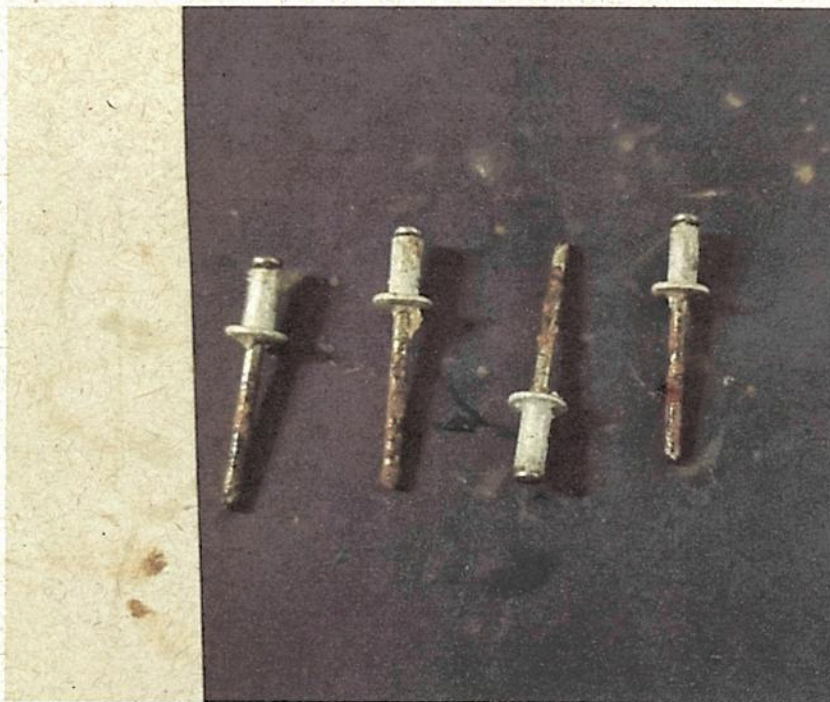
Foto nº. 03 Corrosão dos rebites.
