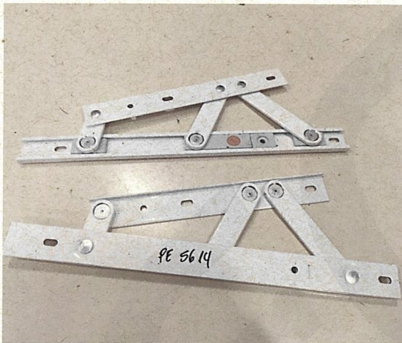
Foto nº. 01 Vista dos corpos de prova antes da corrosão.
