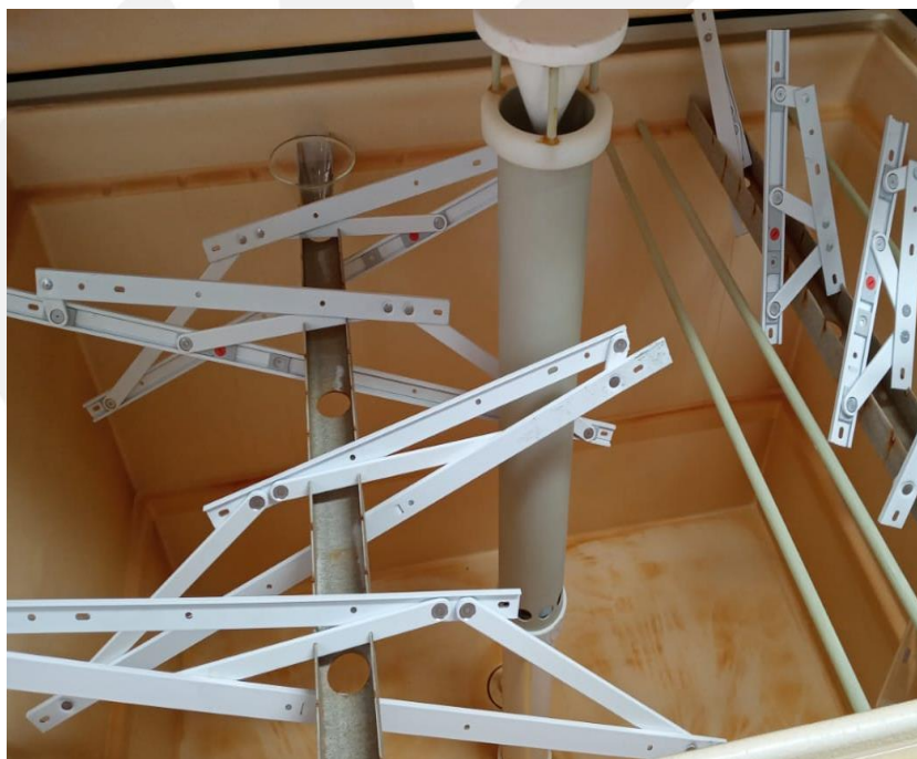
Foto nº. 02 Vista dos corpos de prova na câmara de corrosão.
