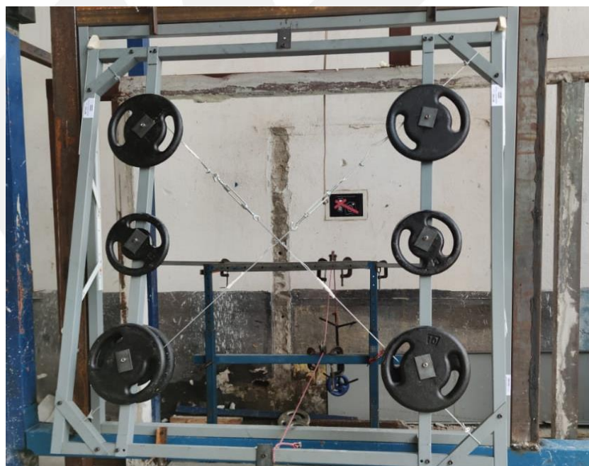
Foto nº. 06 Ensaio de resistência ao impacto e arrancamento na abertura.
