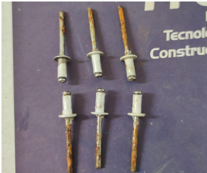
Foto nº. 03 Corrosão dos rebites.
