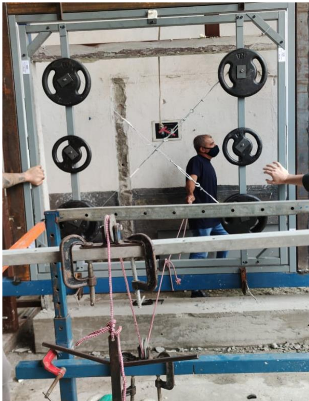
Foto nº. 05 Ensaio de resistência ao fechamento com presença de obstruções.
